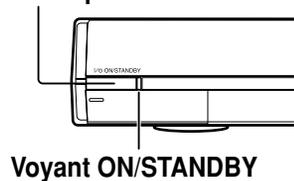
Lorsque l'appareil s'allume, le voyant ON/STANDBY sur le panneau avant passe du rouge (mode d'attente) au bleu (en service).
