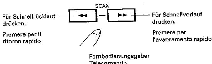
In den ersten zwei Sekunden nach Drücken der Taste wird Low-Scan durchgeführt, danach schaltet das Gerät auf High-Scan.
