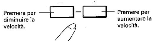
Con i tasti + e -, la velocità di riproduzione può essere cambiata da x3 a 1/90 della normale velocità di riproduzione. Durante l'operazione di riproduzione a velocità multipla il suono viene silenziato.
