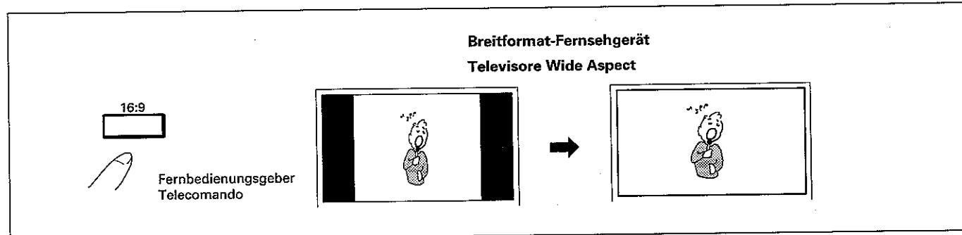
Während der Wiedergabe die Taste 16:9 an der Fernbedienung drücken. Bei Squeezed-LD-Discs wird das Bild passend für das Breitformat-Fernsehgerät erweitert.
