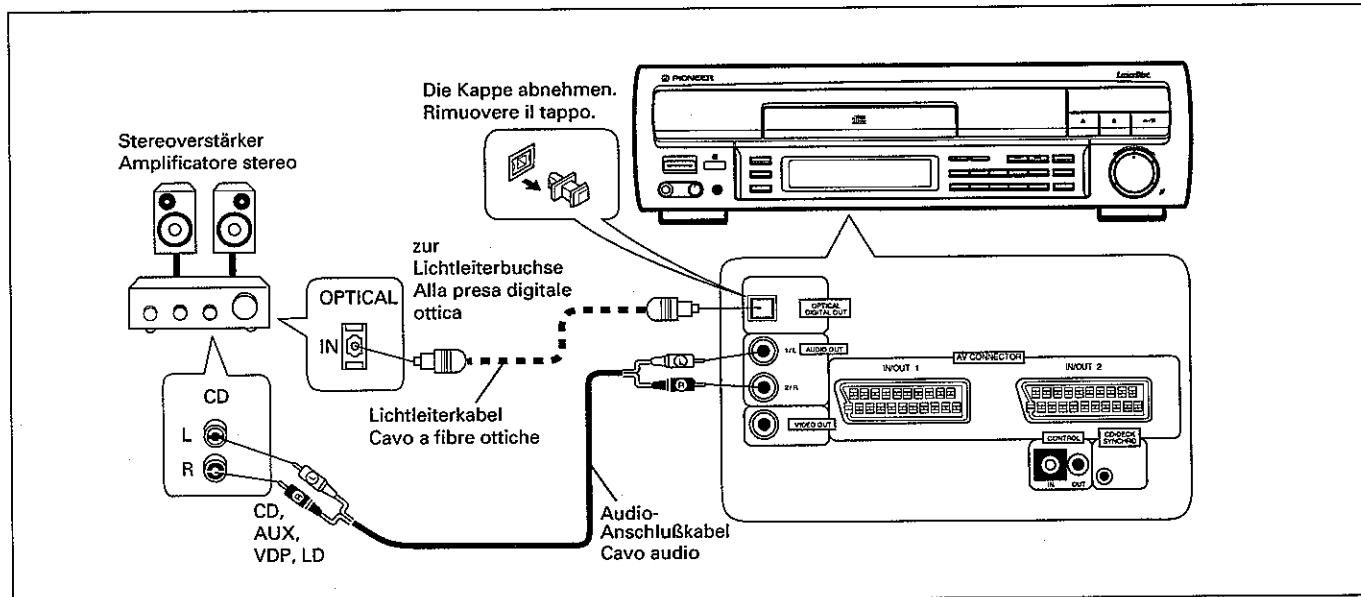
Die AUDIO OUT-Buchsen des Spielers mit den AUX-, CD-, LD- oder VDP-Eingangsbuchsen des Stereoverstärkers verbinden.
